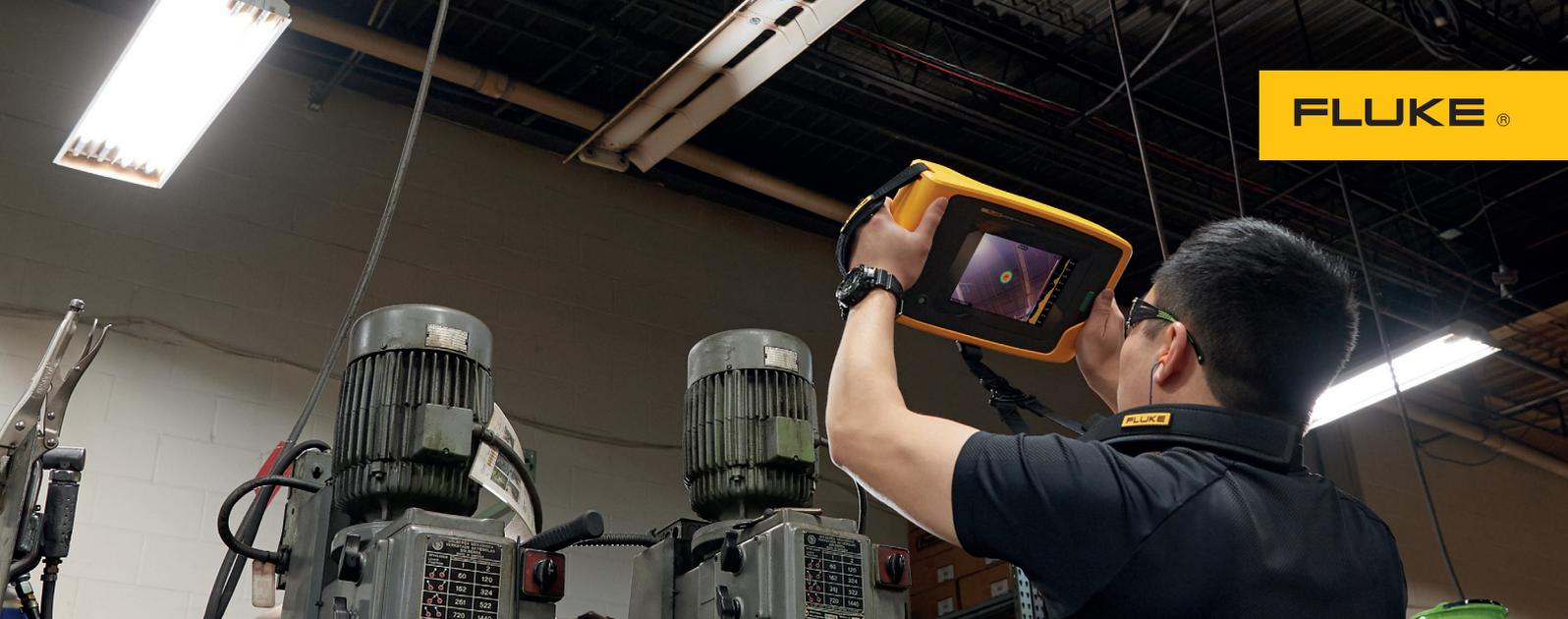
Inspección de los conductos de aire comprimido con la cámara acústica industrial ii900
